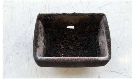
BEISPIEL VERSCHMUTZTE BRENNSCHALE
