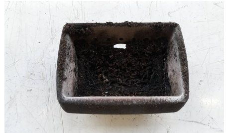
BEISPIEL VERSCHMUTZTE BRENNSCHALE
