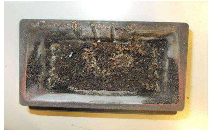
Nur eine angemessene Wartung und Reinigung des Gerätes BEISPIEL VERSCHMUTZTE BRENNSCHALE
